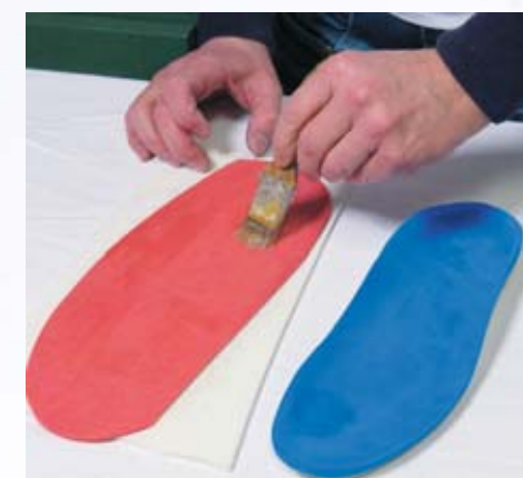
Aufbringen einer zusätzlichen Polsterschicht (Memory-Schaum) Applying an additional upholstery layer (memory foam)
