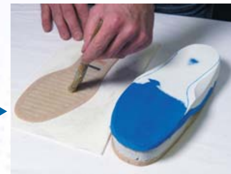
Einstreichen und Verklebung der Flexitec-Basissohle auf den Untergrund Brushing and gluing of the FLEXITEC® Basis-Sole on the ground
