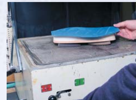
1. Tiefziehen der Basisschale Deep drawing of the base shell
