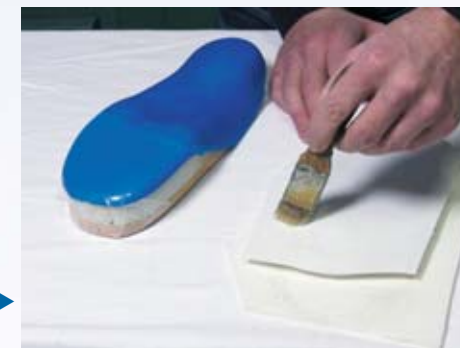
2. Verklebung eines Rückfußkeils Gluing of a backfoot support
