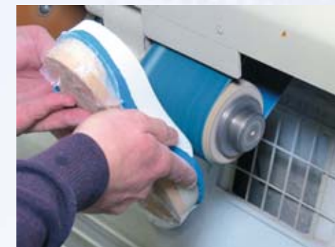
3. Ganz wichtig: Planschleifen des Untergrunds Very important: surface grinding of the ground
