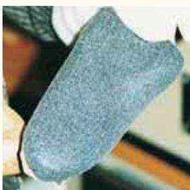
Nach kurzer Abkühlzeit hält der Thermoplast die Form und kann aus dem VACUTHERM und von der Positiv-Form abgenommen werden.
