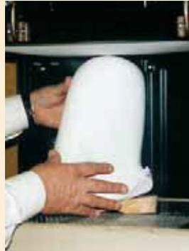
Die Materialien werden in den Spannrahmen des VACUTHERMs eingespannt und unter den Strahlern erhitzt.
