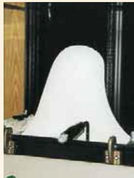
Anschließend wird der heiße Zuschnitt über das Positiv gefahren und das Vakuum genommen. Diesen Vorgang bezeichnet man als „Tiefziehen“.
